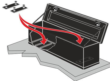
5. Befestigungsbohrungen durch den Boden der Pritschenbox und die Ladefläche bohren und evtl. gegen Korrosion schützen.
